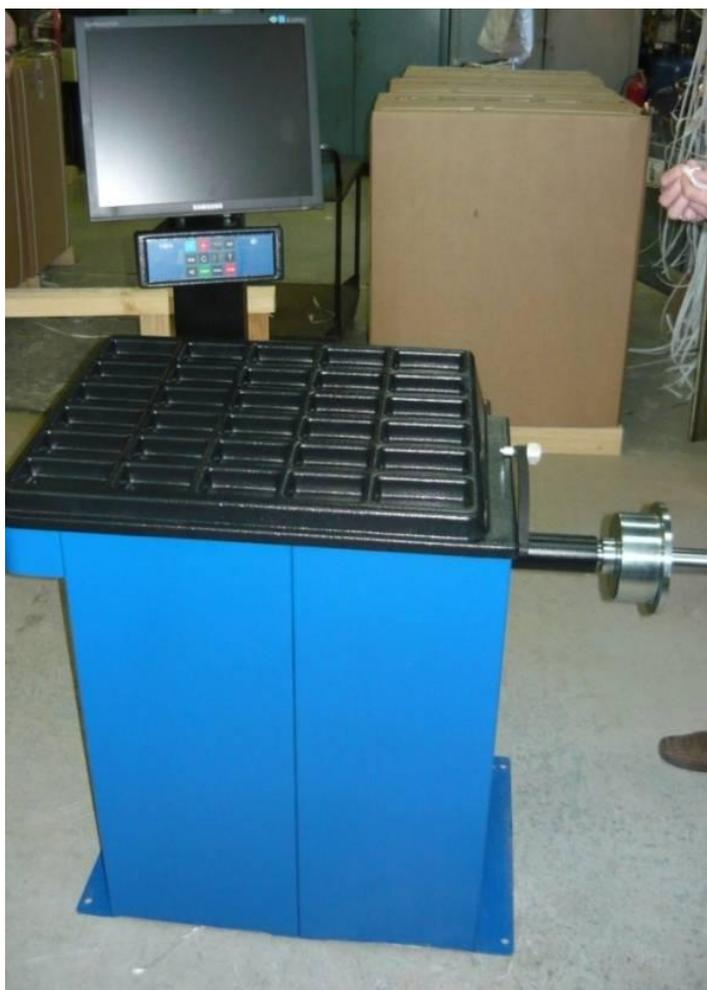
Рисунок 1 – Общий вид станка балансировочного ЛС.
