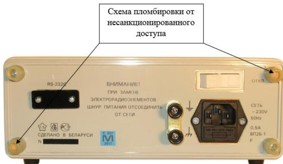
Рисунок 2 — Схема пломбировки от несанкционированного доступа
