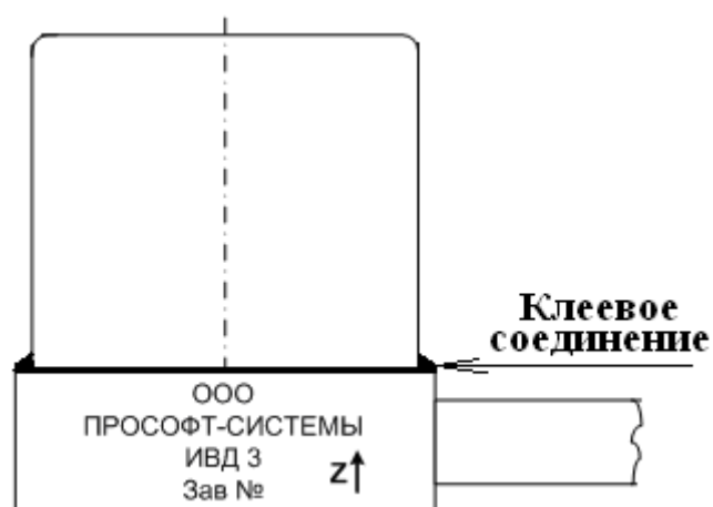
Рисунок 2. Схема пломбировки датчика от несанкционированного доступа.
