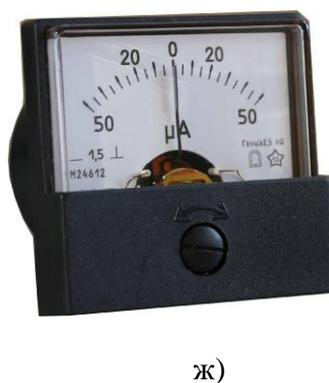
Рисунок 3 - Микроамперметры и милливольтметры щитовые
