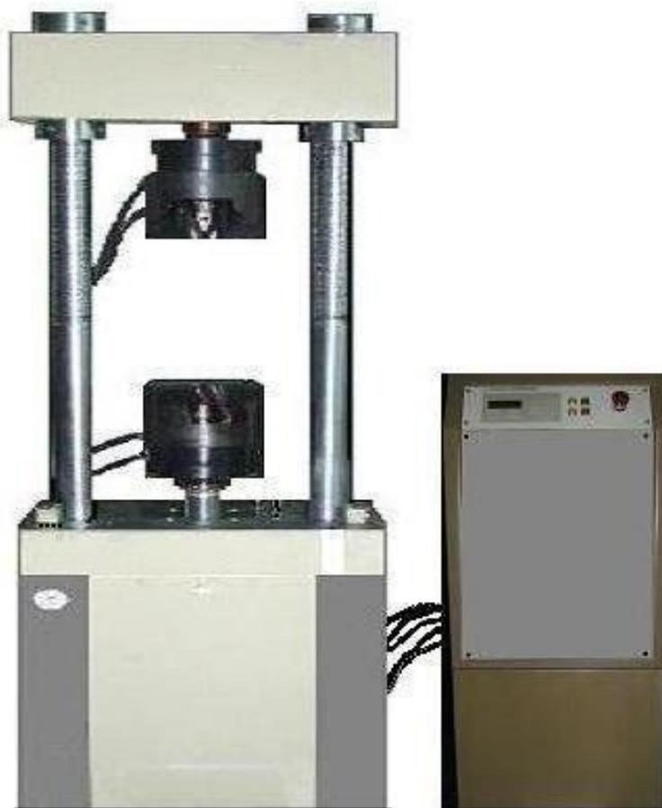
Рис.2 Общий вид машины испытаний на растяжение типа ИРэ с одним гидроцилиндром
