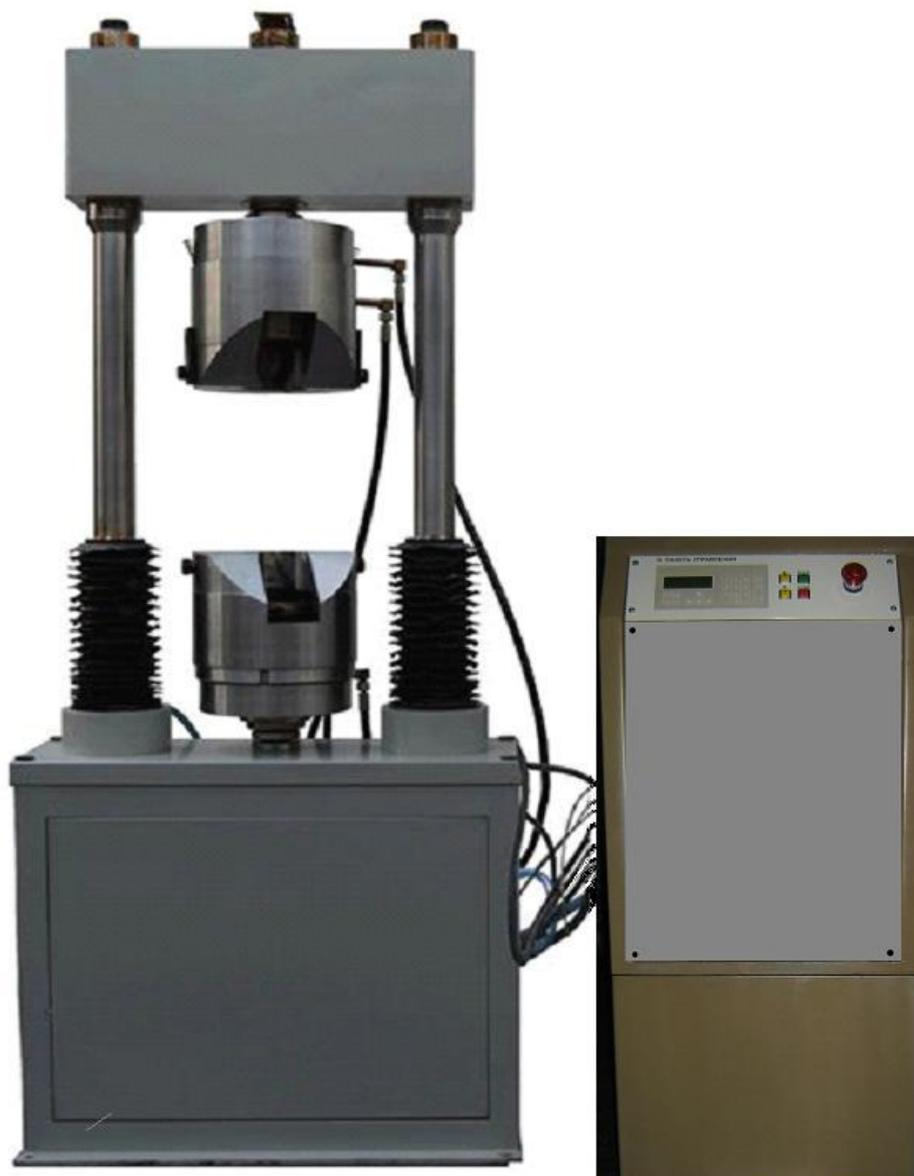
Рис. 1 Общий вид машины испытаний на растяжение типа ИРЭ с двумя гидроцилиндрами
