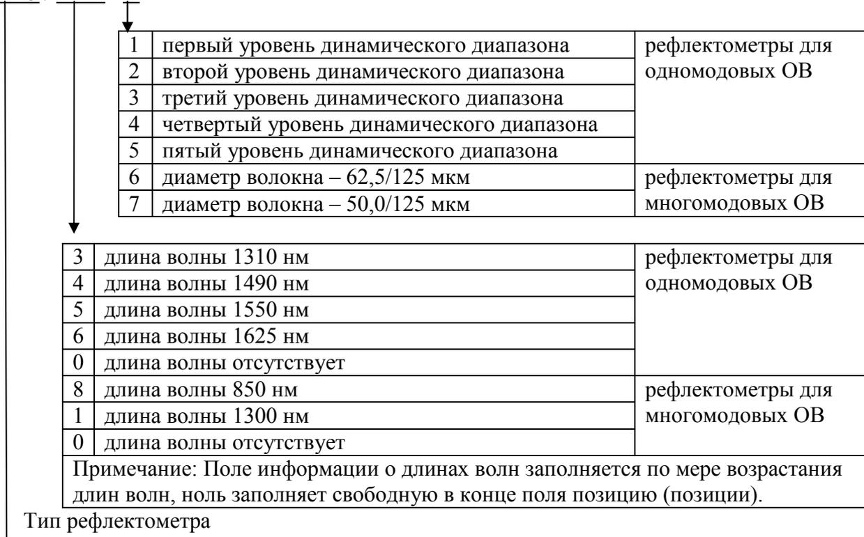
Рисунок 1 - Схема конфигурации рефлектометра ОР-2-3
