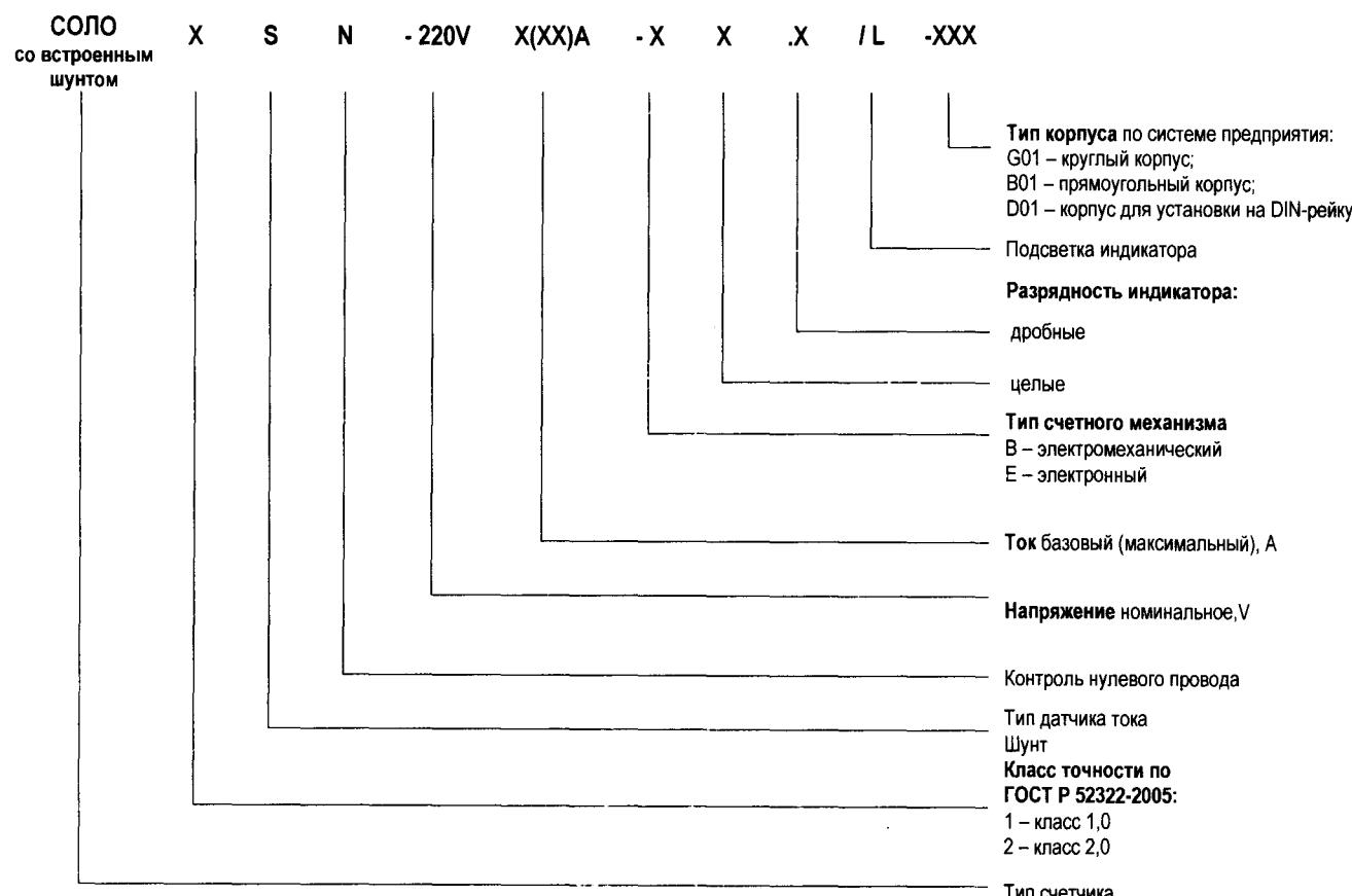
П р и м е ч а н и е – маркировка варианта исполнения счетчика на щитке может не содержать информации, являющейся очевидной на образце или представленной на щитке в другом виде.
