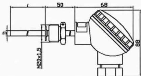
Рисунок 1. Внешний вид термопреобразователя сопротивления ТСП.
