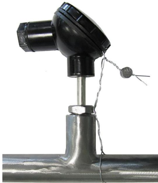
Рисунок 8 - Схема пломбировки ТС
