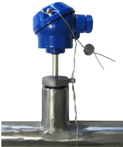
Рисунок 7 - Схема пломбировки ТС
