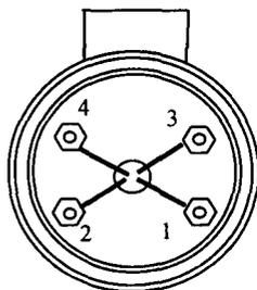
Рисунок 2. Условное обозначение схемы соединений внутренних проводников термопреобразователя по ГОСТ 6651.
