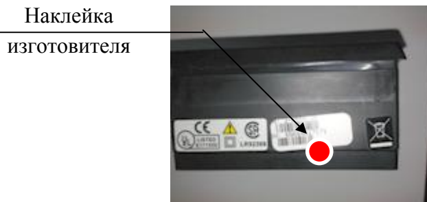
Рисунок 12 – Место пломбировки приборов модификаций 8550
