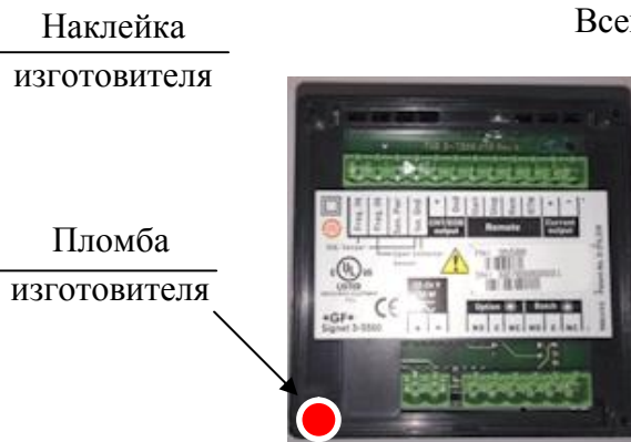
Рисунок 10 – Место пломбировки приборов модификаций 5500, 5600 и 5075
