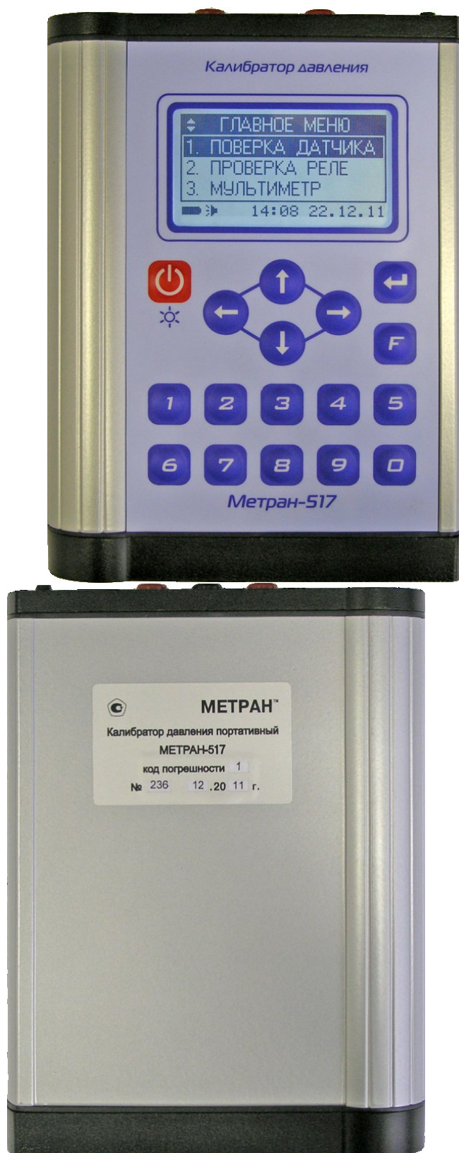
Рисунок 1 – Внешний вид калибратора Метран-517
