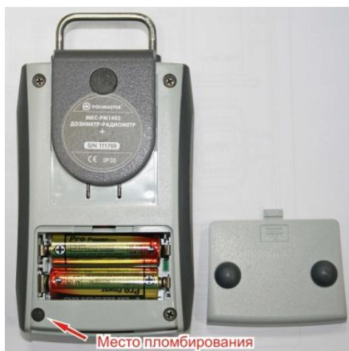
Рисунок 2 – Место пломбирования дозиметров-радиометров MKC-PM1405
