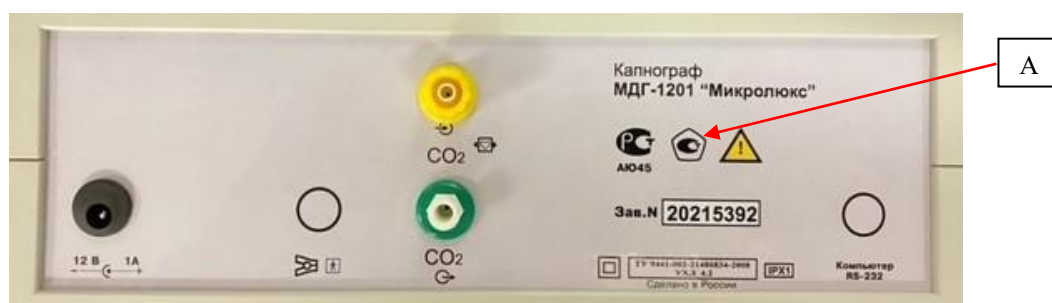
Рисунок 2 – Место нанесения знака утверждения типа (А)
