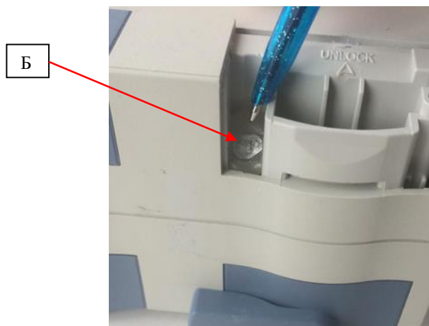
Рисунок 3 – Схема пломбирования капнографов от несанкционированного доступа (Б)
