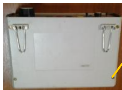
Рисунок 2- Схема пломбировки прибора
