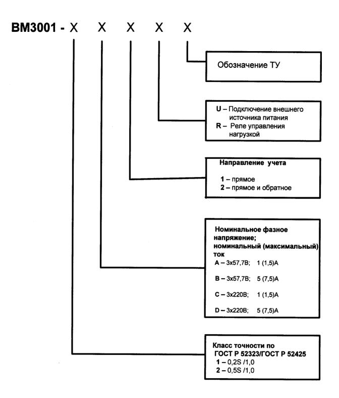
Рисунок 1 – Структура условного обозначения счетчиков
