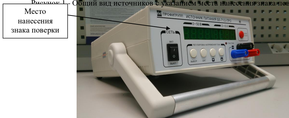
Рисунок 1. Общий вид источников с указанием места нанесения знака поверки
