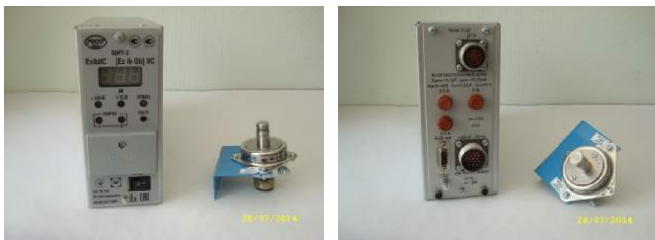
Рис. 1. Фотография общего вида сигнализаторов горючих газов и паров термохимические ЩИТ-2 и блока управления У-20.
