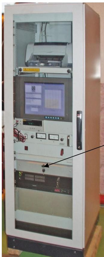
Рисунок 1 - Общий вид средства измерений и обозначение места пломбировки от несанкционированного доступа
