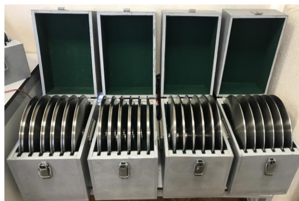
Рисунок 2 – Общий вид комплекта грузов из состава манометра грузопоршневого МП-600
