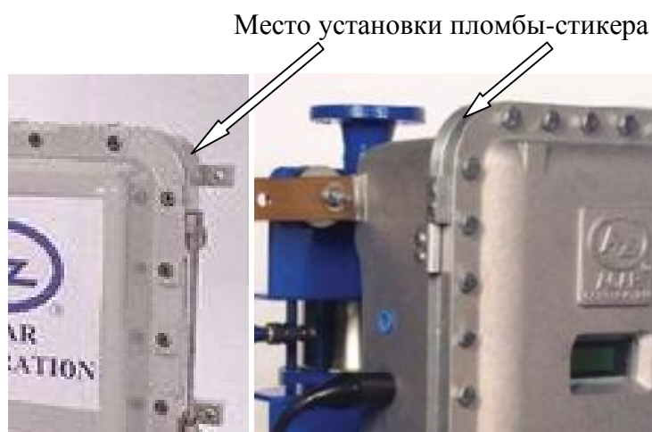
Рисунок 3 – Место пломбирования влагомеров нефти AGAR OW
