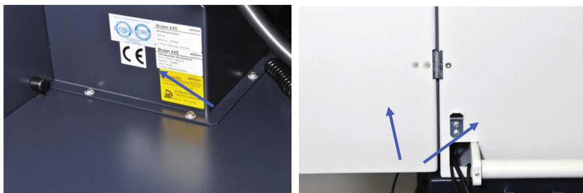
Рисунок 2 – Защита спектрометров рентгенофлуоресцентных S8 LION от несанкционированного доступа.
