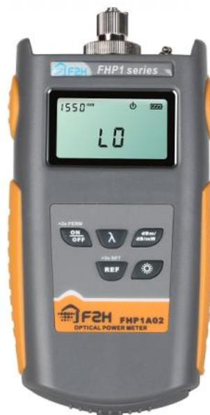
Рисунок 1 - Внешний вид измерителя оптической мощности FHP, модели FHP1A02
