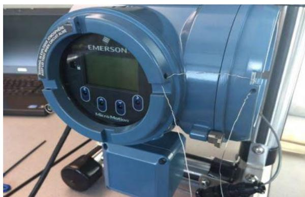
Рисунок 8 - Вариант пломбирования корпуса электронного преобразователя модели 5700
