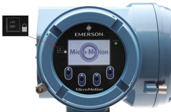
Рисунок 11 - Переключатель защиты от записи электронного преобразователя модели 5700
