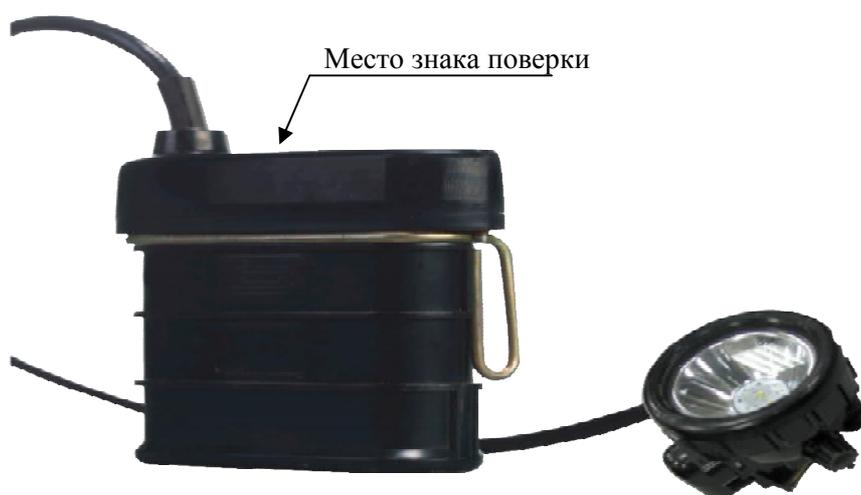
Рисунок 1 - Общий вид сигнализаторов метана СМС-5
