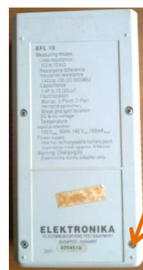
Рисунок 2 - Схема пломбировки прибора
