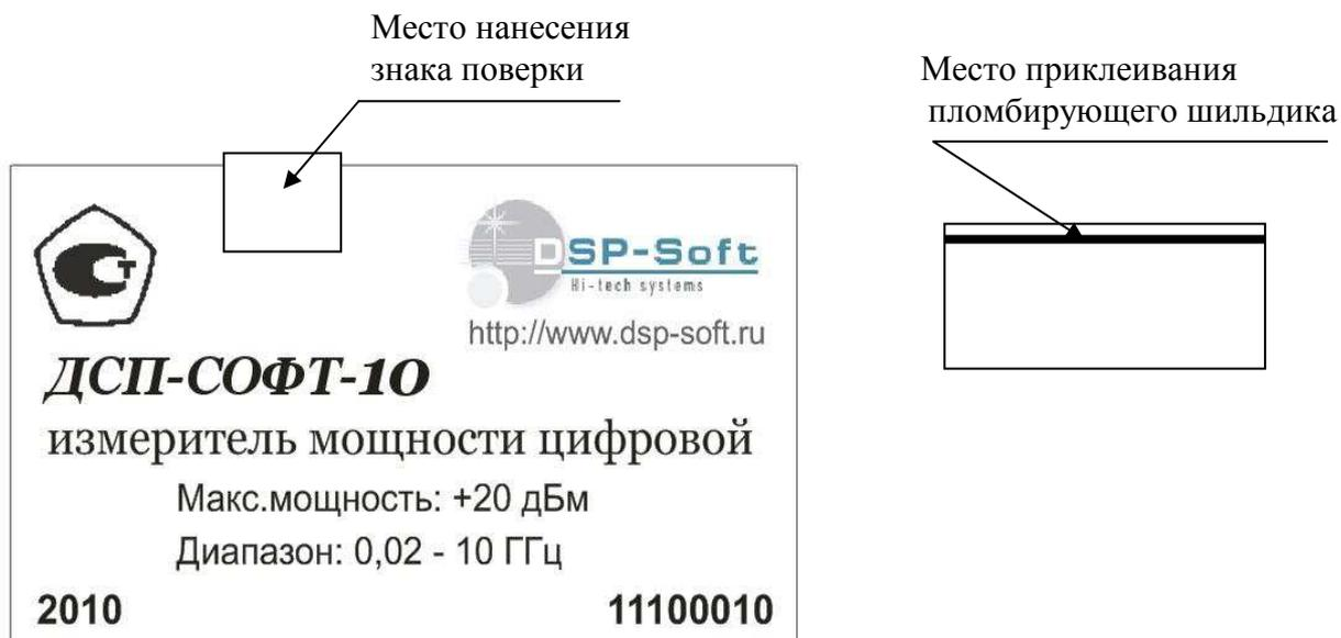
Рисунок 2 – Схема нанесения пломбирующего шильдика и знака поверки
