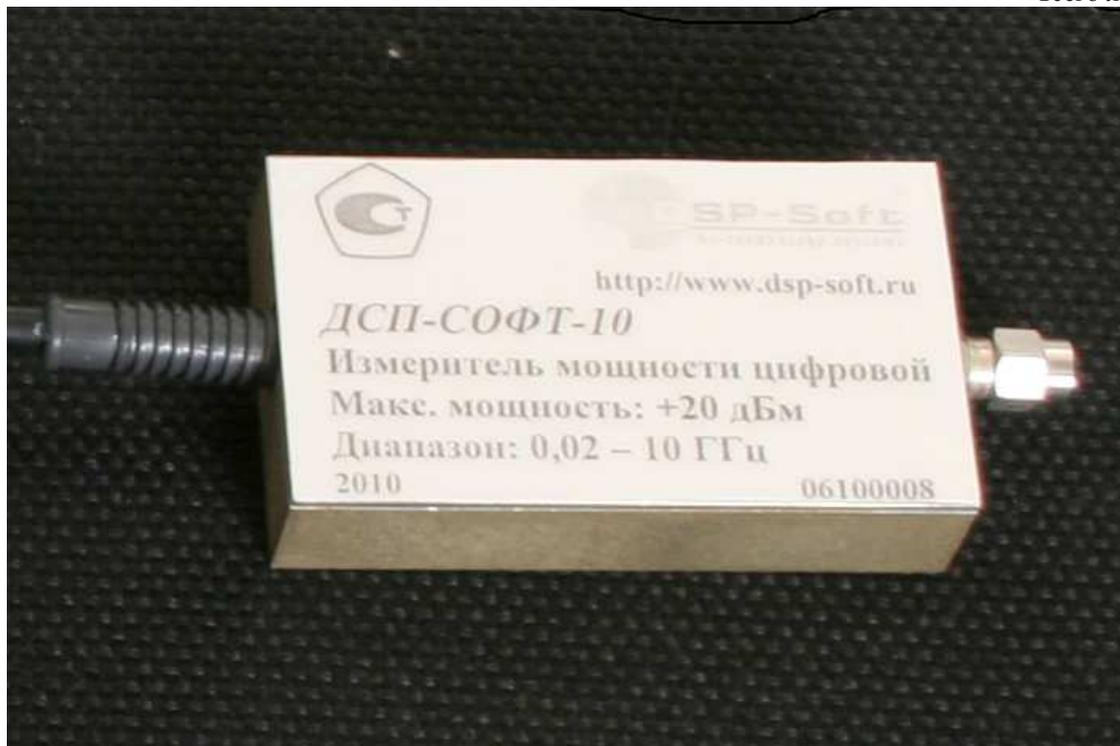
Рисунок 1 – Внешний вид измерителя мощности цифрового DSP-SOFT
