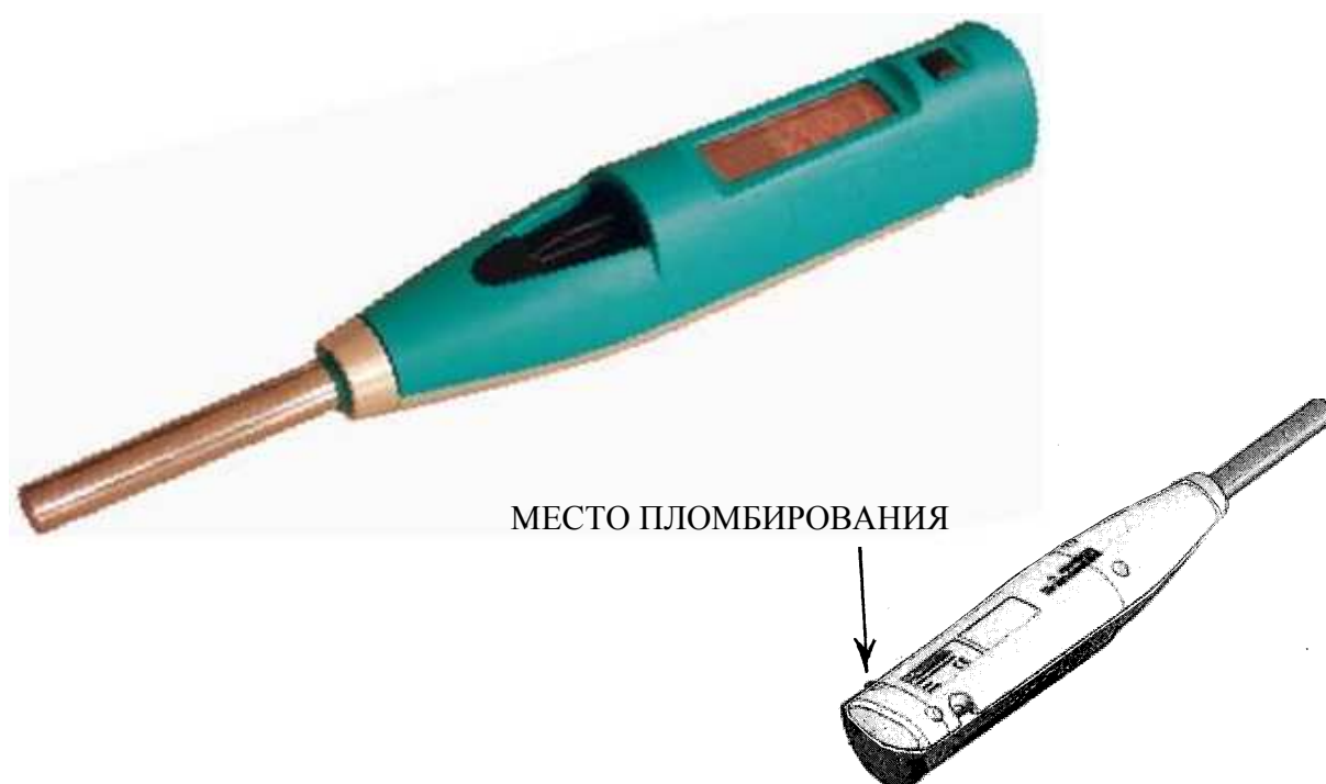
Рис.1. Общий вид приборов SilverSchmidt и расположение пломбы
