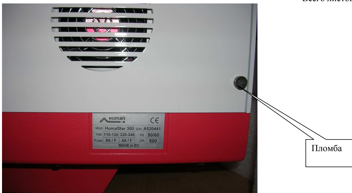
Рисунок 2 – Расположение пломбы. Анализатор биохимический HUMASTAR 300
