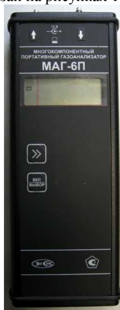
Рисунок 1 – Внешний вид газоанализатора МАГ-6 модификации МАГ-6 П
