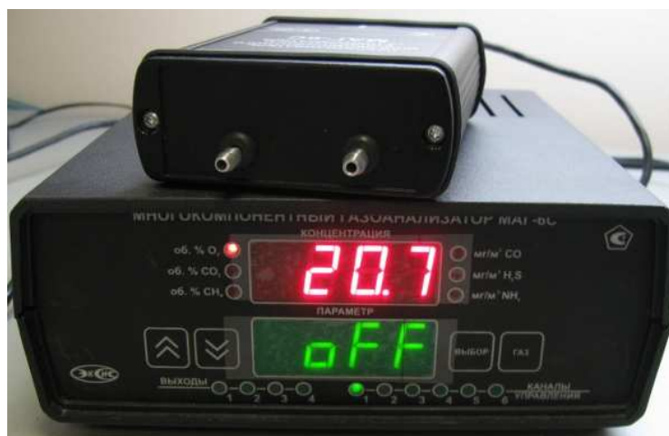
Рисунок 2 – Внешний вид газоанализатора МАГ-6 модификации МАГ-6 С (с одним внешним измерительным преобразователем)
