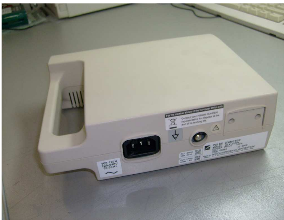
Рисунок 2 – Пульсоксиметр OLV-2700 К. Расположение пломбы.
