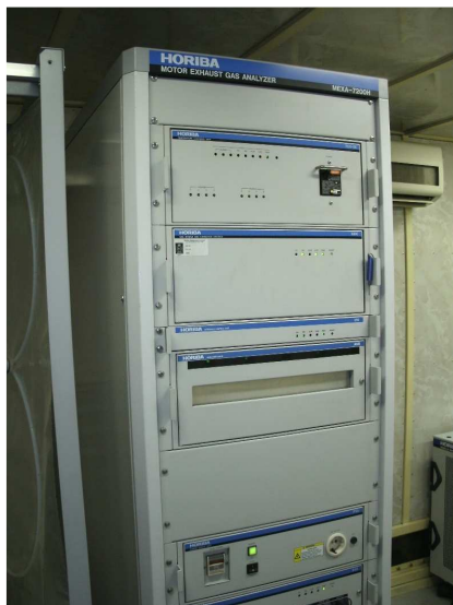
Рисунок 1 – Общий вид стенда (стойка МЕХА-7200Н и стойка ОVN-723А).
