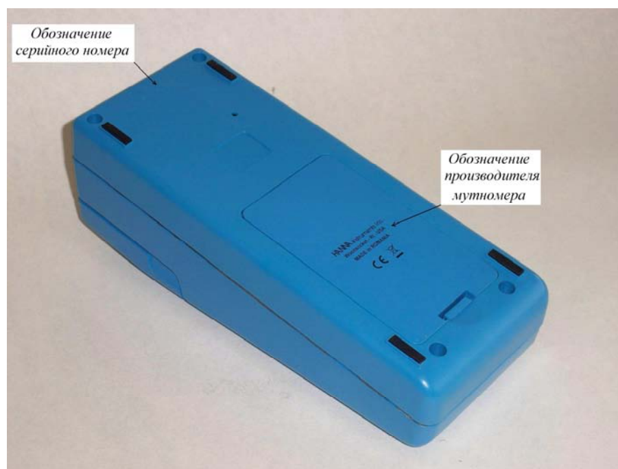
Рисунок 2. Внешний вид нижней стороны мутномера с обозначением места отиска производителя и серийного номера
