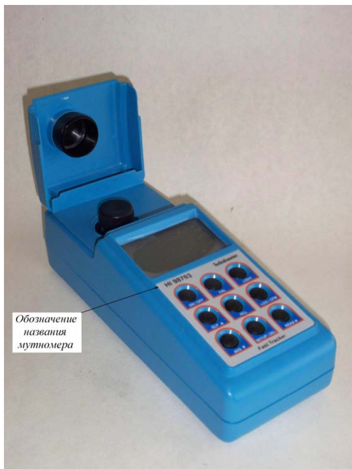
Рисунок 1. Внешний вид мутномера
