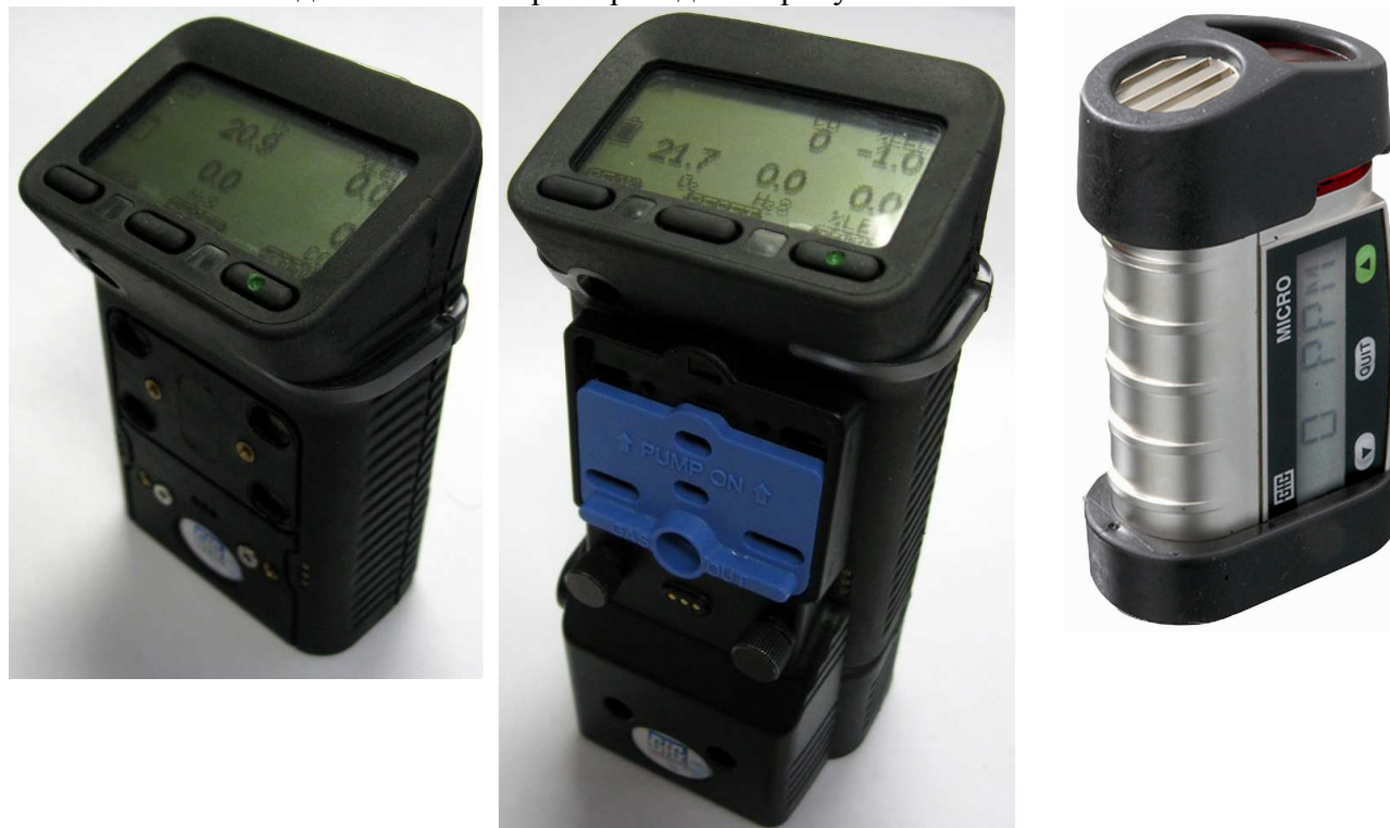
Рисунок 1 - Газоанализаторы модели Microtector II G450, Microtector II G460 (с присоединенным блоком побудителя расхода), Micro IV
