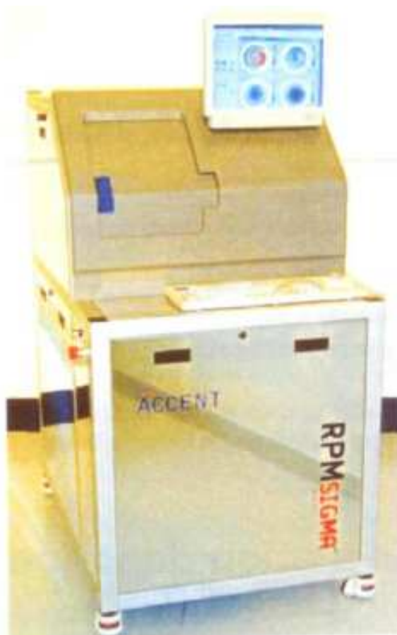
Рис. 1. Внешний вид установки для измерения спектров фотолуминесценции RPM Sigma
