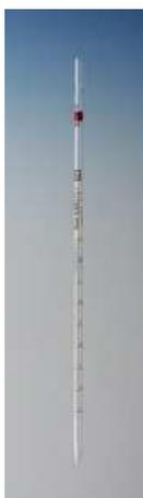
Пипетки представляют собой прямые стеклянные цилиндрические трубки с узким оттянутым концом и с нанесенными на них шкалами.
