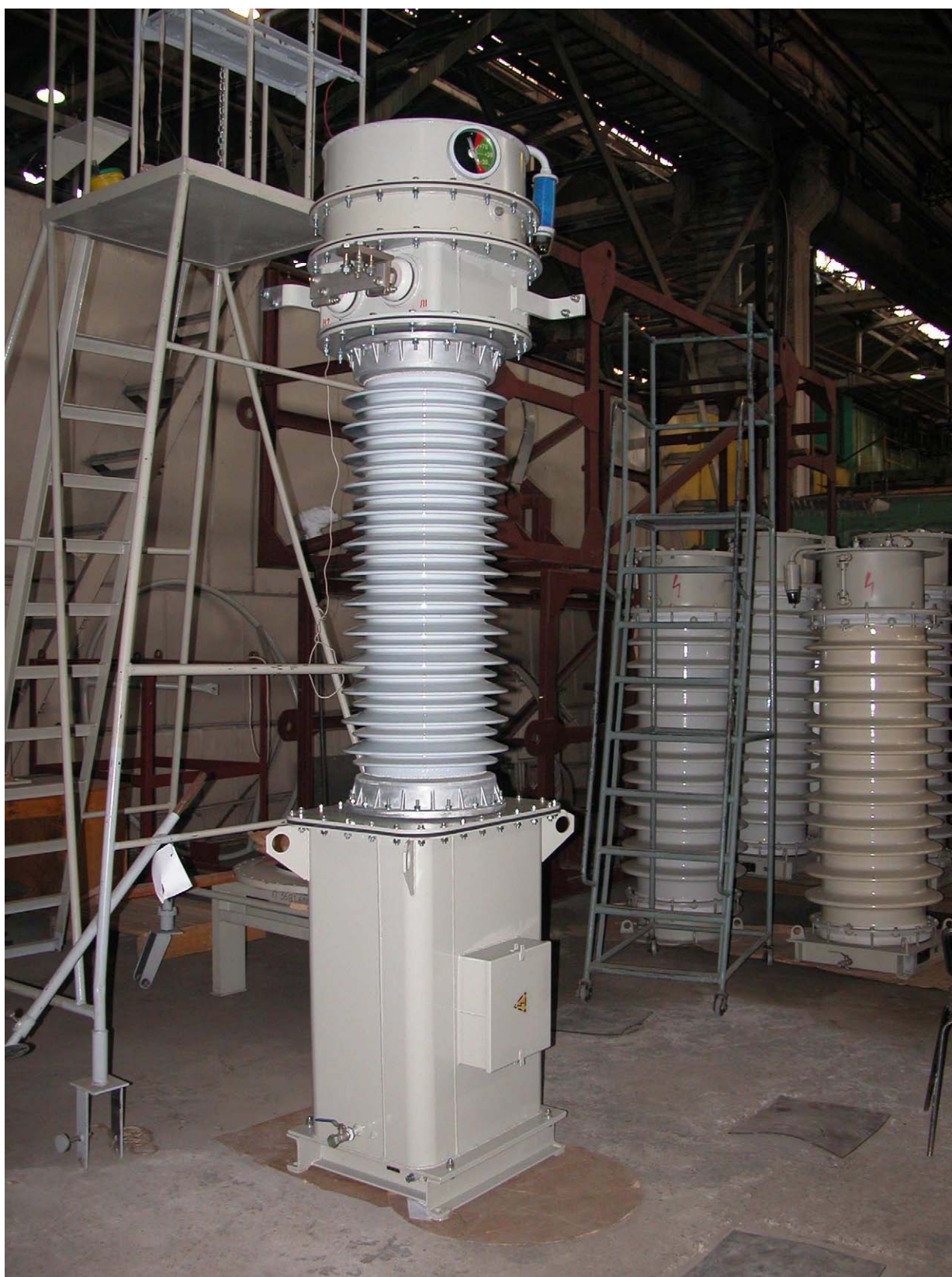
Рис.1 Трансформатор тока ТФБ 110
