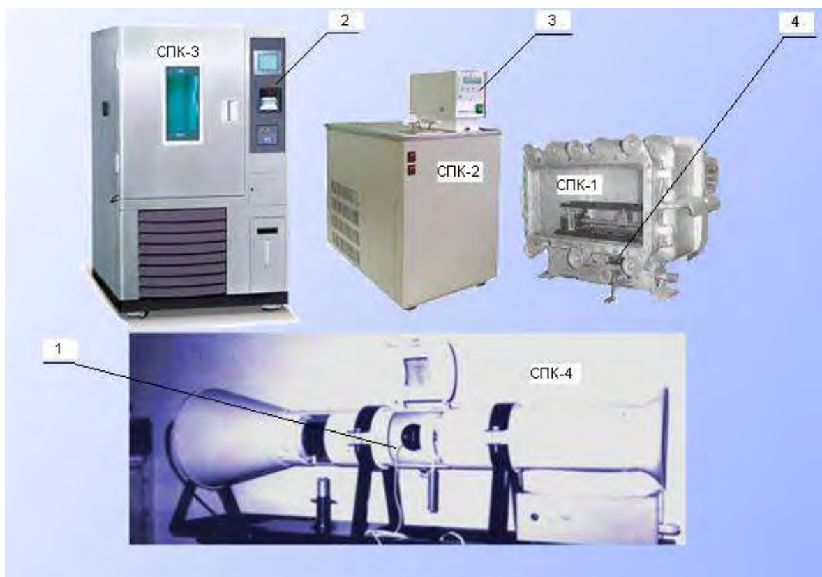
Рис. 2 Фотография общего вида СПЛ – 1 и места пломбирования составных частей СПК – 1, СПК – 2, СПК – 3 и СПК – 4 (отмечены выносками 1–4)
