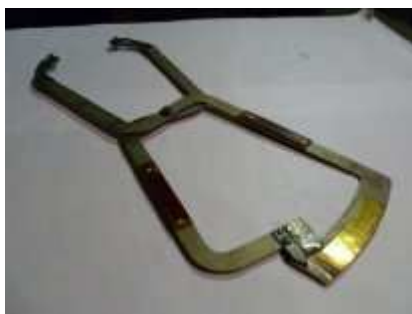
Рисунок 1 - Кронциркуль для измерений толщины диска колес
