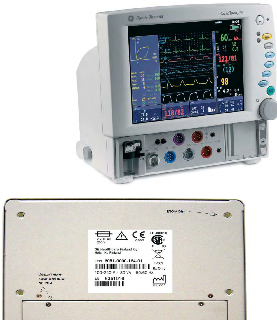
Рисунок 1. Расположение защитных элементов системы, ограничивающих доступ к определенным частям мониторов прикроватных гемодинамических и газовых для анестезиологии и реанимации Cardiocap 5 с принадлежностями в целях предотвращения несанкционированной настройки и вмешательства, которые могут привести к искажению результатов измерений
