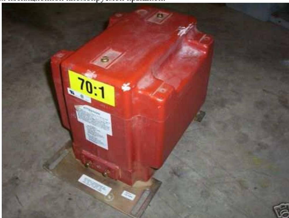
Высоковольтные выводы первичной обмотки расположены в верхней части корпуса трансформаторов. Для защиты первичной обмотки в ее цепь на специальных клипсах устанавливается предохранитель.
