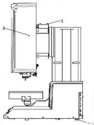
Рис.4 схема пломбировки прибора. 1,2,3 - места пломбировки.
