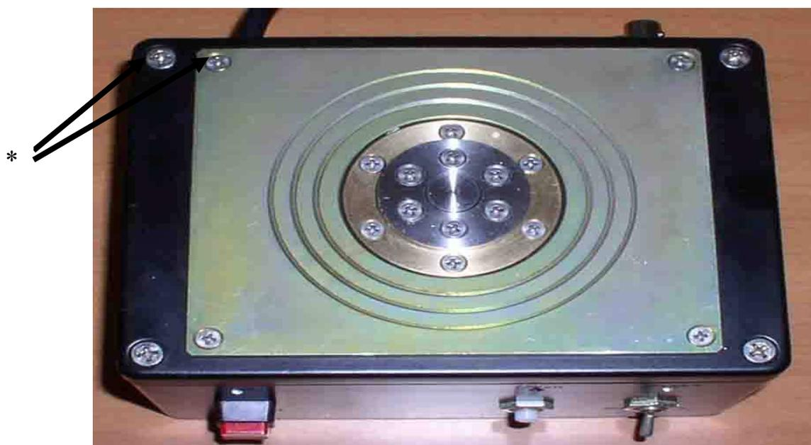
Примечание: \* - места пломбировки от несанкционированного доступа.
