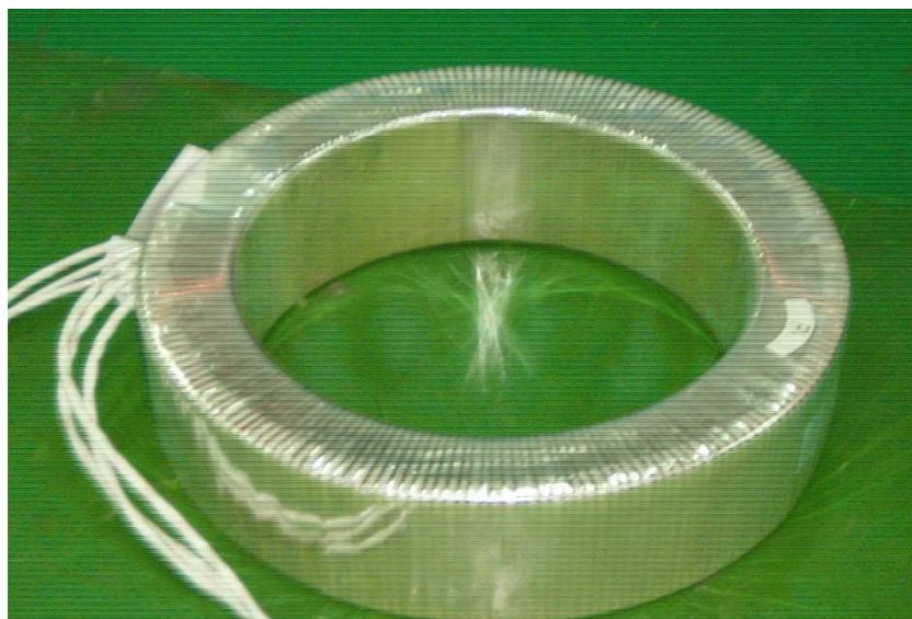
Первичной обмоткой трансформатора является токоведущая шина внутри ввода. Выводы вторичных обмоток и вывод заземления расположены в коробке вторичных выводов, закрытой крышкой с возможностью пломбирования. Обмотки равномерно намотаны на ленточные тороидальные магнитопроводы и покрыты эпоксидным компаундом. Возможно обеспечение одного,
