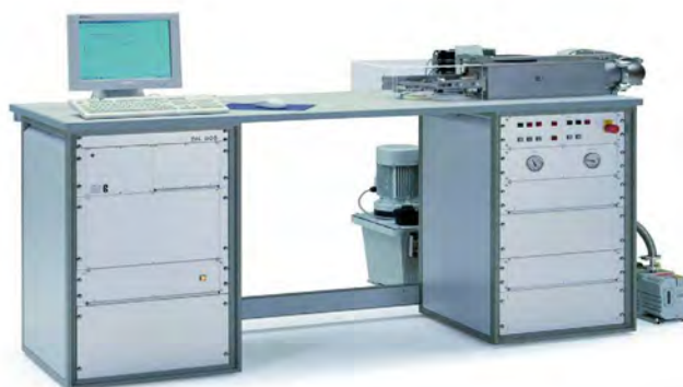
Рисунок 1- Внешний вид дилатометра закалочного и деформирующего DIL 805 A/D
