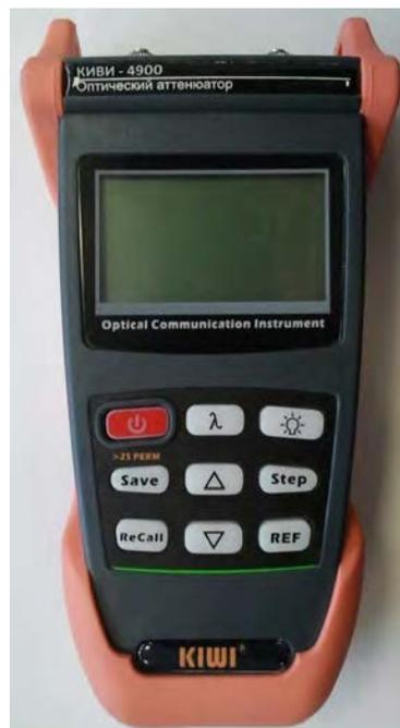
Рисунок 6 – аттенюатор оптический КИВИ-4900
