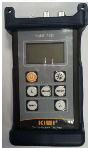
Рисунок 4 – Тестер оптический КИВИ-445Х
