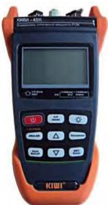
Рисунок 5 – Измеритель оптической мощности КИВИ-451Х
