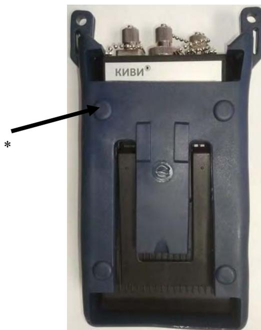
Рисунок 8 - Схема пломбировки от несанкционированного доступа моделей КИВИ-445Х
