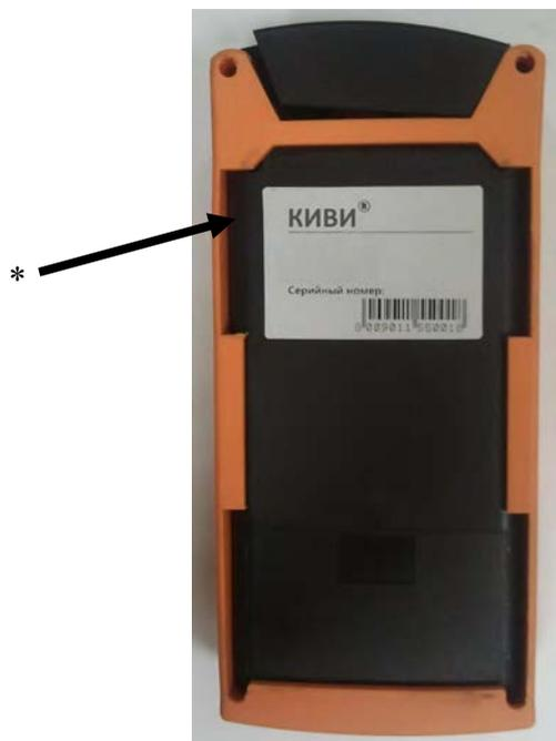
Рисунок 7 - Схема пломбировки от несанкционированного доступа моделей КИВИ-420Х, КИВИ-430Х, КИВИ-440Х
