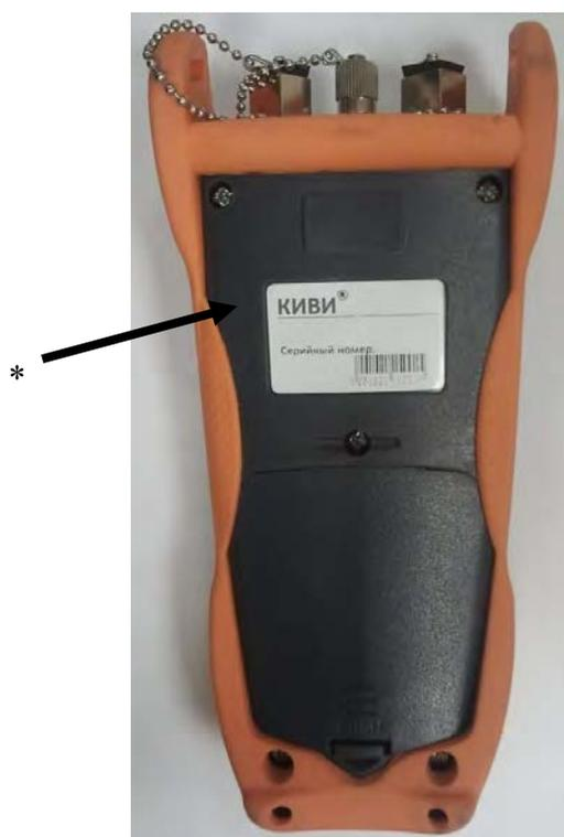
Рисунок 9 - Схема пломбировки от несанкционированного доступа моделей КИВИ-451Х, КИВИ-490Х
