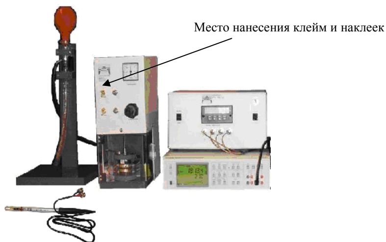
Рисунок 1 – Фото общего вида анализатора удельного электрического сопротивления керна горных пород AERS-702
