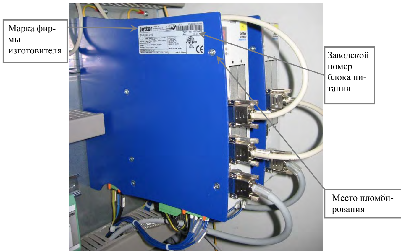
Рисунок 4 – Схема маркировки блока питания Jetter JM 206B-230
