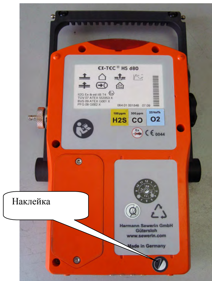
Рисунок 3 – Схема пломбировки сигнализатора от несанкционированного доступа
