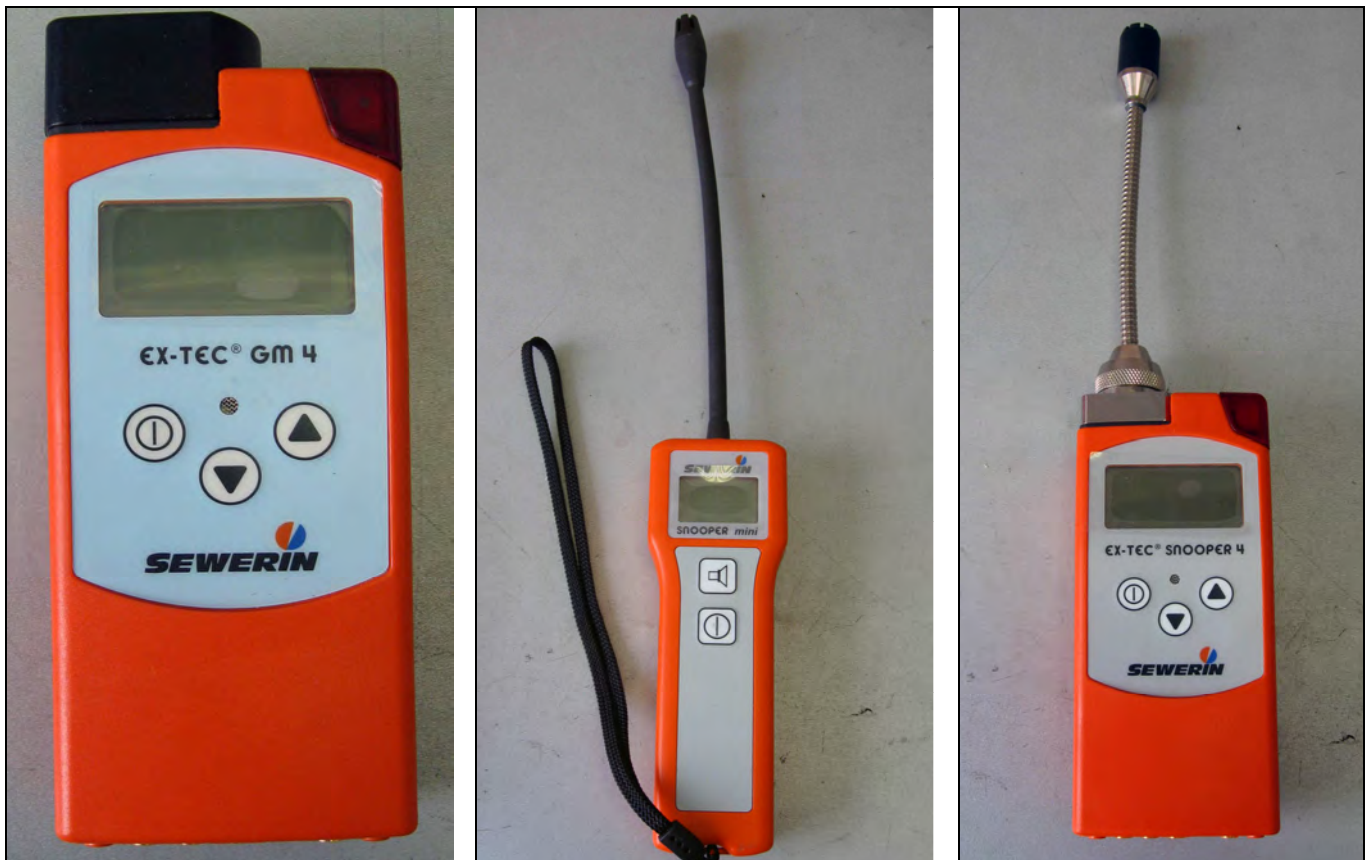
Рисунок 2 – Внешний вид газоанализаторов моделей GM4, Snoopер mini и Snoopер 4
