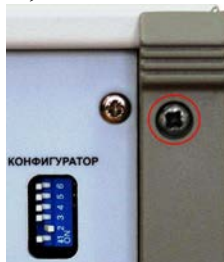
Рисунок 3 – Место на задней панели для пломбирования (отмечено красным)
