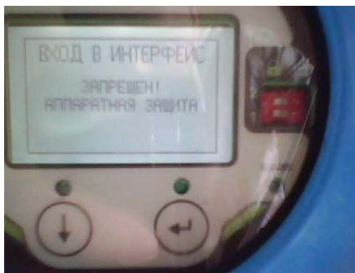
Рисунок 3 – Микропереключатели находятся в положении «ON», изменение параметров невозможно, на экране находится запрещающее сообщение.
