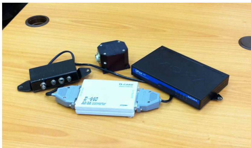
Рисунок 3 - Блок инерциальный измерительный БИ-221, аналогово-цифровой преобразователь E-440, преобразователь USB-RS-232, блок коммутации
